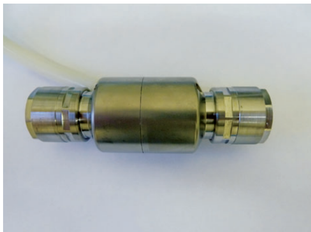
Рис. 2. Осевой насос с новыми узлами стыковки входной и выходной магистралей
