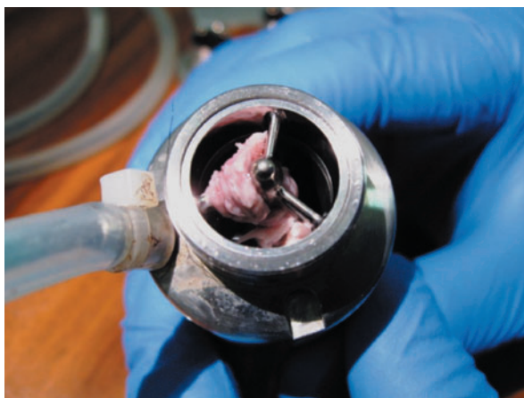
Рис. 1. Тромбоз вокруг выходной опоры, перекрывающий проточное сечение на 60–70% (модель 1)
