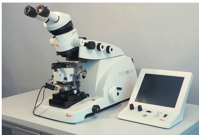
Рис. 1. Экспериментальная установка для сканирующей зондовой нанотомографии Ntegra Tomo, комбинирующая ультрамикротом и сканирующий зондовый микроскоп
