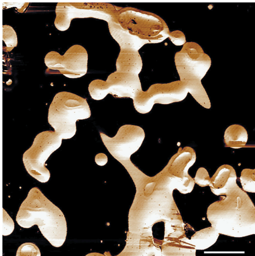
Рис. 7. СЗМ-изображение поверхности среза электроспиннингового полиуретанового матрикса. Метод отображения фазы, размер изображения 37,34 \times 37,34 мкм, размерный отрезок 5 мкм
