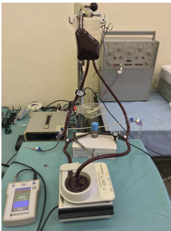
Рисунок 57. Стенд для проведения сравнительных гемолизных испытаний насоса Rotaflow в неп пульсирующем (с зажимом на Ш) и пульсирующем режимах (без зажима)
