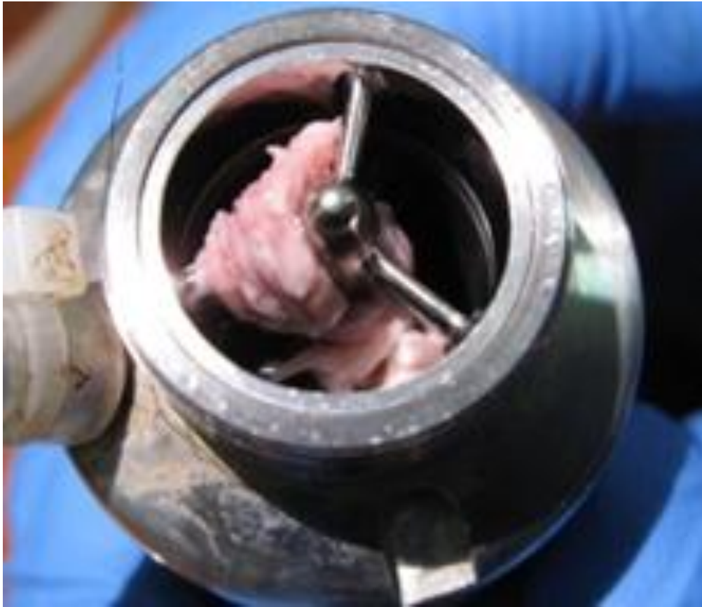
Рисунок 5. Тромбоз вокруг выходной опоры, перекрывающий проточное сечение на 60-70%.
