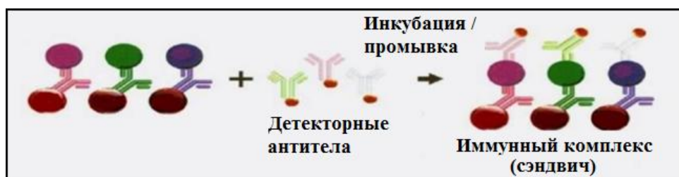
Рисунок 2 – Второй этап мультиплексного анализа. Детектирование захваченного аналита
