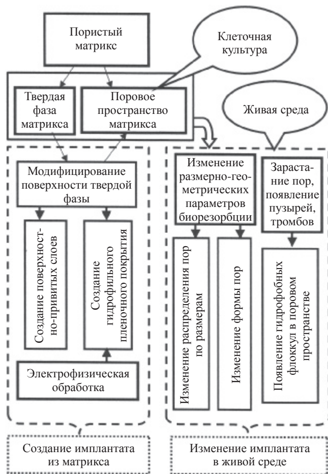
Рис. 1. Модельная схема создания имплантата из пористого матрикса и его взаимодействия с живой средой
