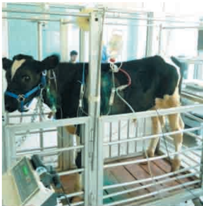
Рис. 2. Теленок с экстракорпорально подсоединенным осевым насосом
