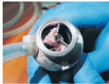
Рис. 6. Тромбоз вокруг выходной опоры, перекрывающий проточное сечение на 60–70%
