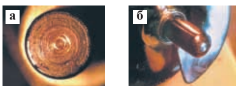
Рис. 5. Механический износ цилиндрических опор, модель 1
