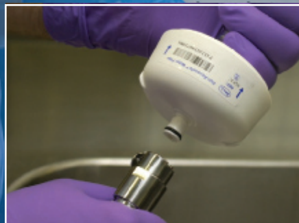
Одноразовый фильтр в линии подачи воды. Быстрая защита.
